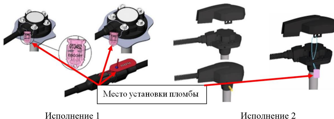
Рисунок 2 – Схема пломбировки от несанкционированного доступа
