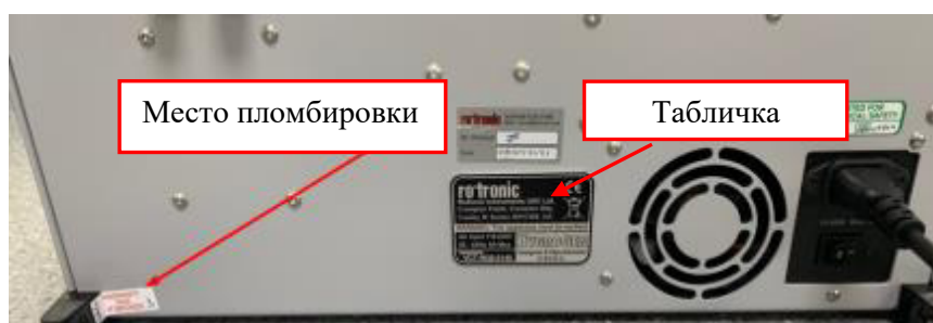
Рисунок 4 – Схема пломбировки от несанкционированного доступа и место расположения таблички с идентификационными данными генератора
