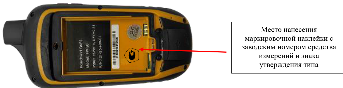
Рисунок 2 - Место расположения маркировочной наклейки с указанием заводского номера аппаратуры и знака утверждения типа
