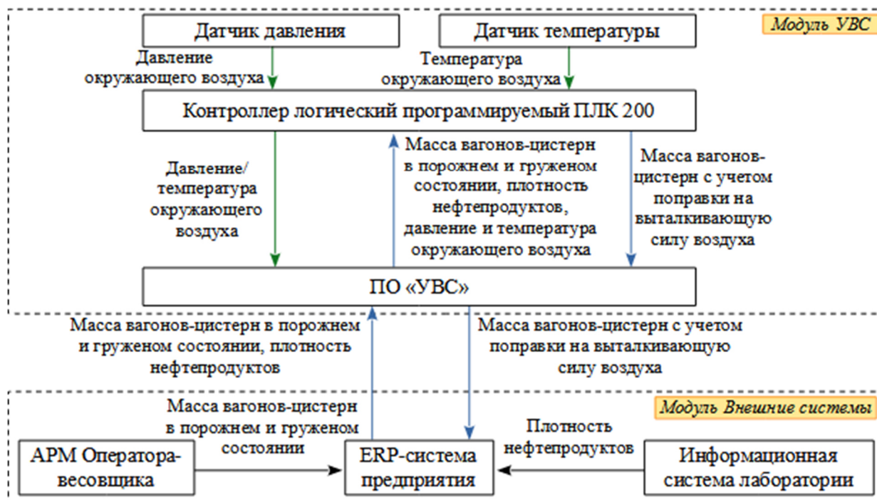
Рисунок 1 – Схема информационных потоков при выполнении измерений
