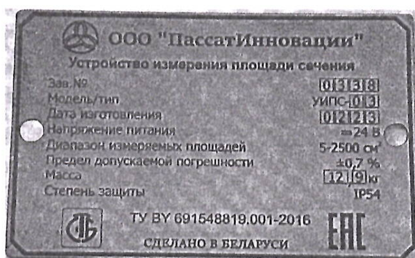
Рисунок 1.3 – Фотография маркировки УИПС (изображение носит иллюстративный характер)
